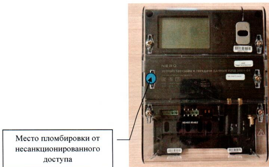
Рисунок 3.1 – Схема пломбировки от несанкционированного доступа (для УСПД 3021-01, УСПД 3021-06)
